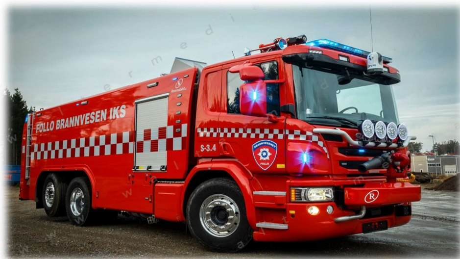
Figur 5 spesialbrannbil ved bruk i tunneler store næringsbygg. Bilen har varmesøkende kamera 2 store vannkanoner. Alt styres fra førerkabin.
