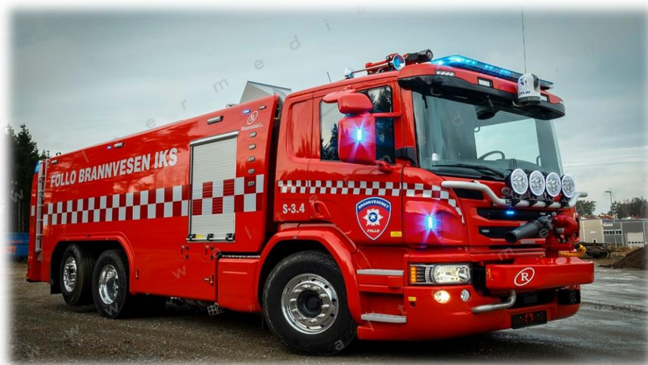
Figur 3 spesialbrannbil ved bruk i tunneler store næringsbygg. Bilen har varmesøkende kamera 2 store vannkanoner. Alt styres fra førerkabin.
